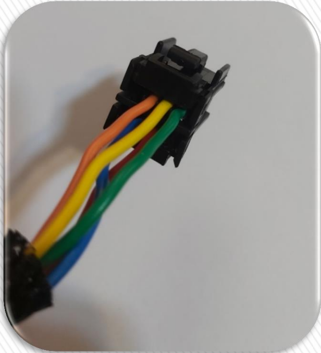
سوکت پدال گاز قبل از خارج نمودن سیم اتصال بدنه
